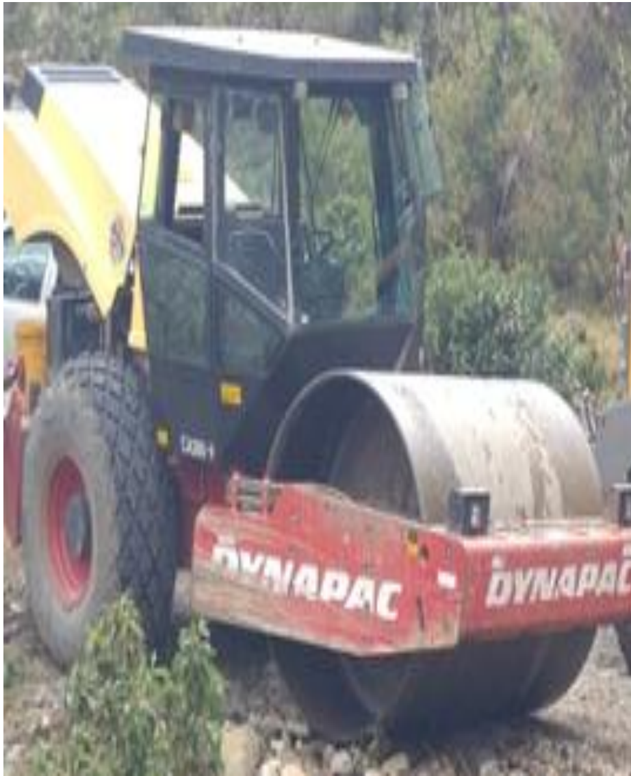
Nota. Se observa las maquinarias, rodillo liso Dynapac CA260D-II, retroexcavadora Case 590 SUPER N
