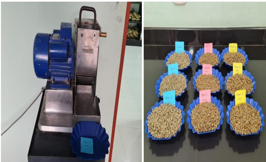
**Fotografía 9.** Tamizado de muestras y determinación de defectos según cuadro de Evaluación del SCA.
